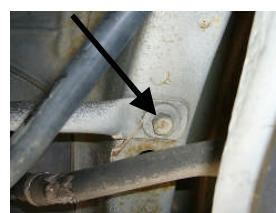
付属のA・Bステーを車両側へ固定して強化ゴムをセットして下さい
